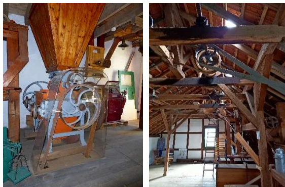
Haferquetsche und Transmission (Foto H-G van Deel)
